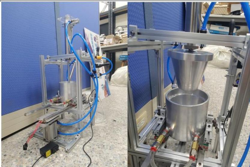
Figure 14 用於壓製育苗杯的自製機台
