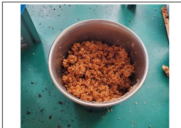
**Figure 12 capa 塑膠與木屑土壤之複合材料**
