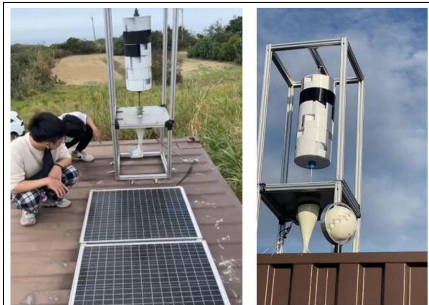
Figure 9 太陽能板及風力發電機
