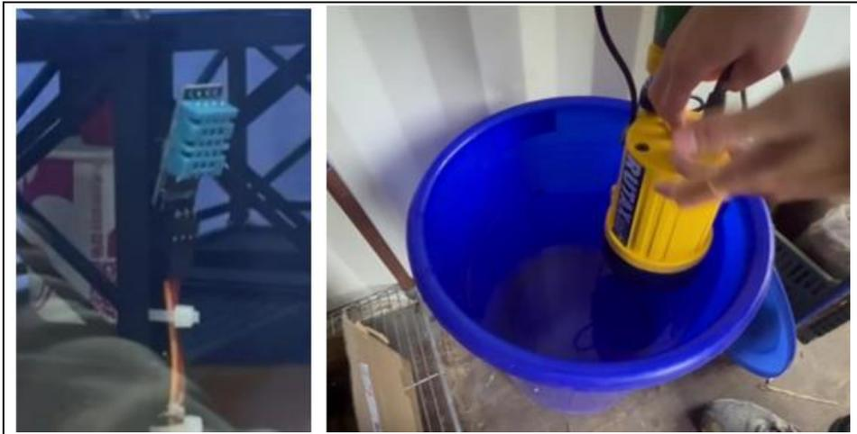
Figure 6 溫溼度感測器與灌溉用抽水馬達
