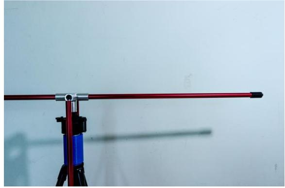
原型機的橫桿連接筒是用3D列印的方式製作，並以熱熔膠固定於發電機上。為了使其更加堅固及達到更好的發電效率，我們購買效率更好、扭矩更大的發電機，重新設計橫桿連接筒的外型並改以鋁金屬訂做而成，使其與發電機完全密合且不需另外使用黏膠固定。
