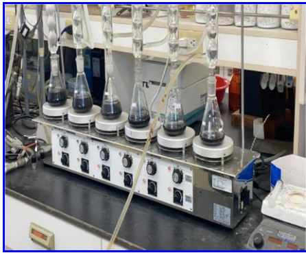
圖2. 含浸鹼灰前處理與後製水洗設備 (磁石攪拌平板加熱器)
