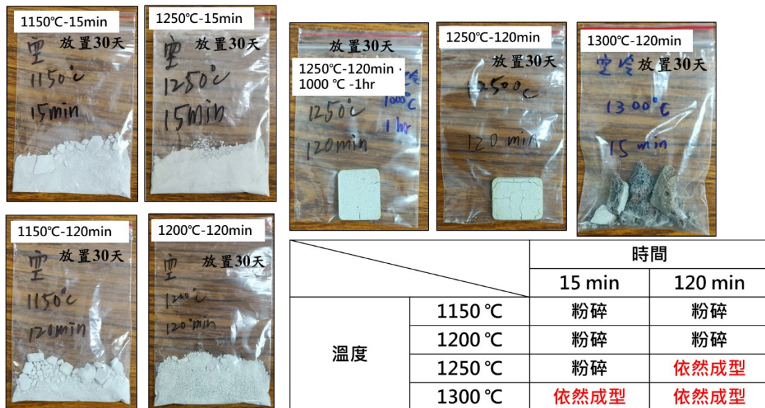
圖 2-9、燒結鋁酸鈣助熔劑經 30 日大氣環境下靜置之結果
