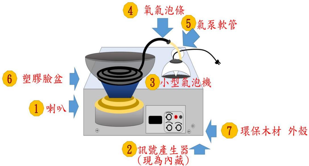
圖 12 低頻氣泡清洗設備 透視圖
