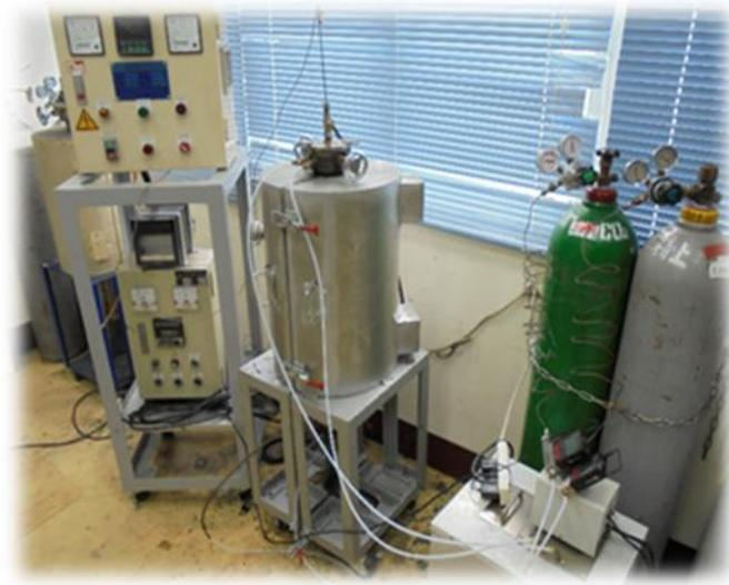
圖 3. 垂直固定床式高溫鍛燒/活化設備系統之實體照片
