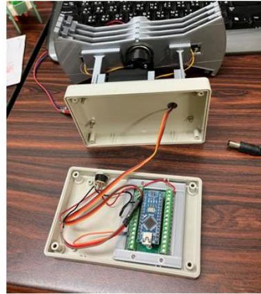
圖10、Arduino控制伺服馬達旋轉
