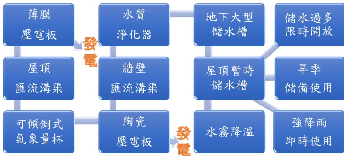
圖 5、雨水收集、儲存、利用流程
