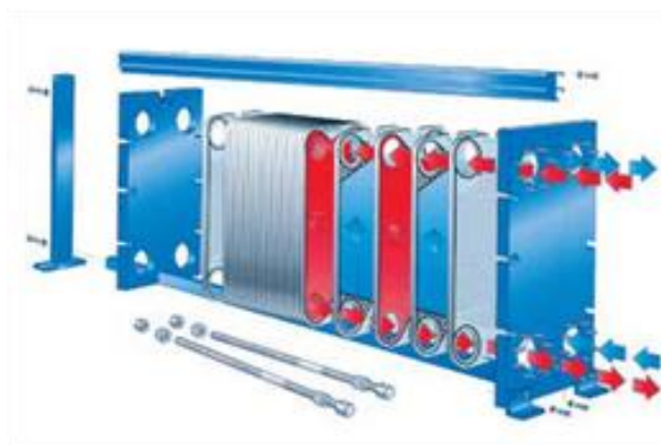
圖 11 板式熱交換器內部構造[9]
