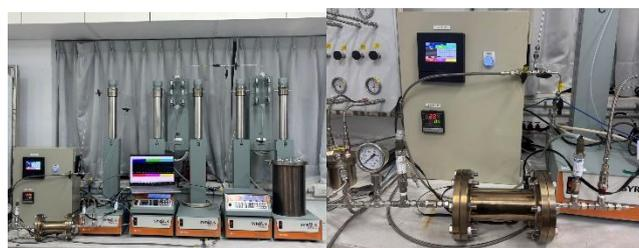
圖 8、加速礦化封存反應設備示意圖
